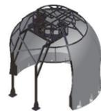
조종수 양성교육 수요를 충족하고 실 장비와 유사한 조종감각 체험을 위한 K9 조종 훈련용 시뮬레이터 시스템
